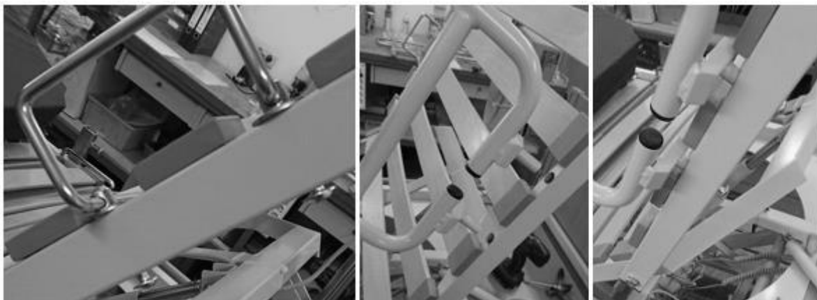
Obrázek 10: Postup při montáži pevných madel místo podpěry matrace
