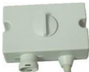
Obrázek 13: krabička s knoflíkem na centrální uzamčení elektrických funkcí
