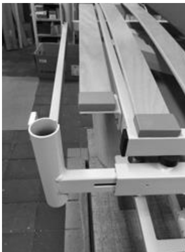
Obrázek 9: Sestavení traverzy hlavy (délka ležící plochy 220 cm)
