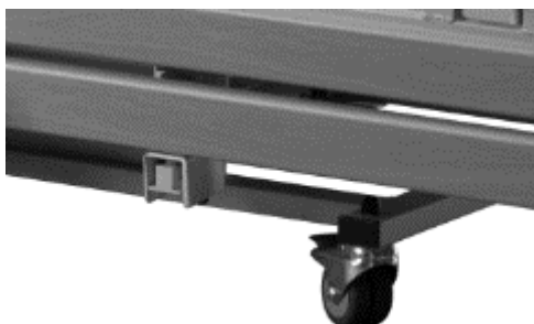
Obrázek 15: Stisknuté tlačítko/limitní spínač přes sníženou boční lištu
