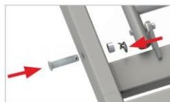
Montáž čepu, distanční vložky a spony typu R
