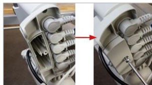
Nasazení krytu baterie – Odšroubujte/příšroubujte kryt baterie na místo pomocí přiloženého šroubu
