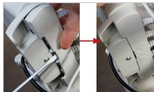
Nasazení krytu kabelů – Kryt kabelů se zacvakne na místo
