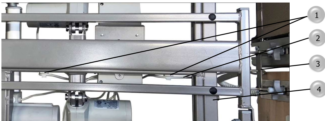
Obrázek 41 – Ruční spínač na levé straně lůžka; 1 Kabelová spona; 2 Kabel ručního spínače; 3 Podélná tyč lehací plochy
