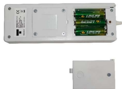
Obrázek 60 – Vysílač s otevřeným krytem baterie; požadované baterie: AA 1,5 V
