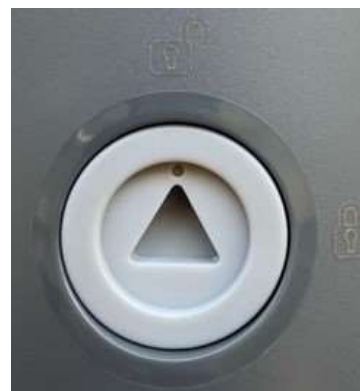
Obrázek 69 – Nastavení spínače, zde: poloha I povolena
